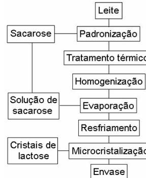
Figura 1 - Fluxograma da fabricação do leite condensado.
